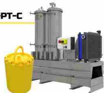
محصولات این خانواده برای تصفیه آلودگی‌های دیزل در توربین‌های گازی تا رده ۰/۱ میکرون بکار می‌رود. این خانواده شامل دستگاه‌های یک، دو، سه، چهار، شش، نه و دوازده فیلتره تا حجم ۱۲۰۰ لیتر و تا دبی ۶ لیتر بر دقیقه است. این دستگاه‌ها مجهز به سیستم خنک کننده برای حذف گسترده وسیعی از آلودگی‌ها هستند و در آنها از کارتریج‌های خانواده DXPT استفاده شده است. علاوه بر این، این دستگاه‌ها با استفاده از انواع الکترومب‌ها متناسب با کاربردهای گوناگون عرضه می‌شود.
