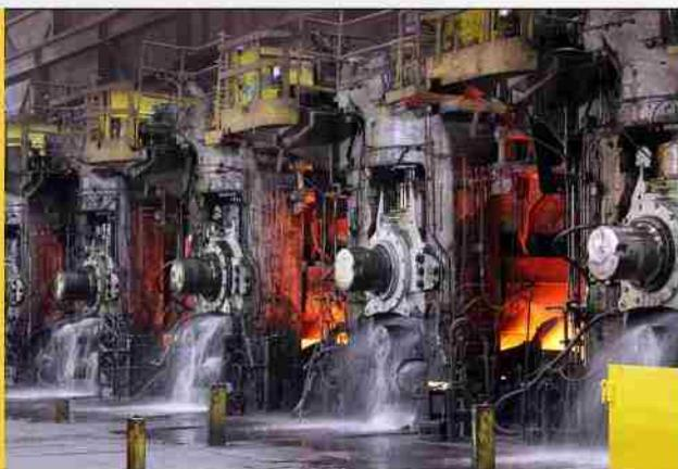
آسیاب‌های نورد از مهم‌ترین تجهیزات در فرآیند تولید فولاد هستند که برای کاهش ضخامت شمش‌ها یا ورق‌های فولادی استفاده می‌شوند.
