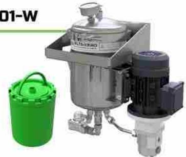
خانواده محصولات فیلتراسیون قابل نصب روی دیوار شامل سه گروه است: دستگاههای تک فیلتره (DX1001-W) تا حجم ۴۵۰۰ لیتر و دبی ۱/۲۵ لیتر بر دقیقه، دو فیلتره (DX1002-W) تا حجم ۹۰۰۰ لیتر و دبی ۲/۵ لیتر بر دقیقه، و سه فیلتره (DX1003-W) تا حجم ۱۳۵۰۰ لیتر و دبی ۳/۷۵ لیتر بر دقیقه. این خانواده برای تصفیه انواع روغنهای هیدرولیک، روانکاری و روغن سوخت و حذف انواع آلودگی‌ها تا رده ۰/۱ میکرون قابل استفاده است. این محصولات در نسخه‌های ضد انفجار (Ex)، با انواع موتورها و تجهیزات جانبی نیز عرضه می‌شود.
