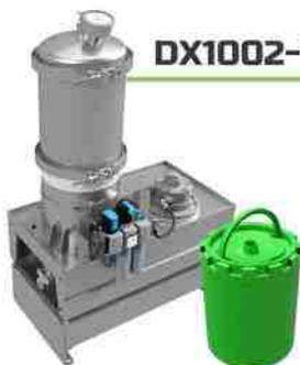
محصولات فیلتراسیون پتوماتیک دلتا بزو در هفت رده شامل دستگاه‌های یک، دو، سه، چهار، شش، نه و دوازده فیلتره برای تصفیه روغن تا حجم ۵۵۰۰۰ لیتر و دبی تا ۱۲ لیتر بر دقیقه طراحی و ساخته شده است. در این دستگاه‌ها از کارتریج‌های DXO دلتا بزو با دقت ۰/۱ میکرون برای حذف انواع آلودگی‌ها شامل باکتری‌ها، آب، و آلودگی‌های ناشی از اکسیداسیون استفاده می‌شود. این محصولات در نسخه ضد انفجار و بصورت نصب روی زمین عرضه می‌شود.
