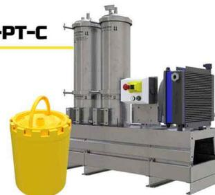
محصولات این خانواده برای تصفیه آلودگی های دیزل در توربین های گازی تا رده ۰/۱ میکرون بکار می رود. این خانواده شامل دستگاه های یک، دو، سه، چهار، شش، نه و دوازده فیلتره تا حجم ۱۲۰۰ لیتر و تا دبی ۶ لیتر بر دقیقه است. این دستگاهها مجهز به سیستم خنک کننده برای حذف گستره وسیعی از آلودگیها هستند و در آنها از کارتریج های خانواده DXPT استفاده شده است. علاوه بر این، این دستگاهها، با استفاده از انواع الکتروپمپها متناسب با کاربردهای گوناگون عرضه می شود.
