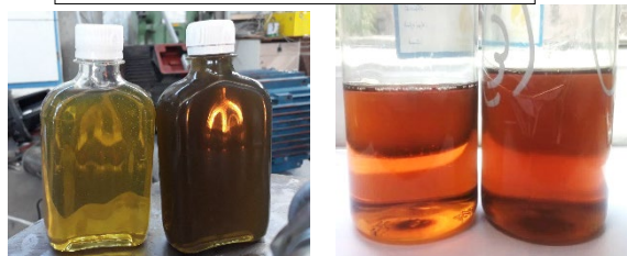
نمونه های روغن قبل و پس از تصفیه ( تصویر چپ روغن دنده و راست روغن هیدرولیک)
