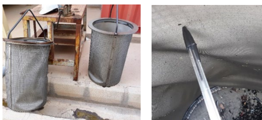
انسداد منافذ فیلترهای روغن و دفرمگی آنها
