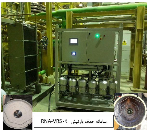
انسداد منافذ فیلترهای روغن و دفرمگی آنها
