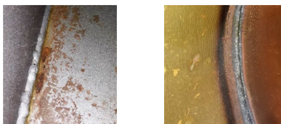
رسوب وارنیش بر جداره مخزن روغن و مسیر روانکاری
