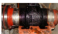
رسوب وارنیش بر شافت توربین و فیلترهای مدار روانکاری
