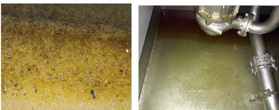
براده های فلزی موجود در مخزن روغن توربین
