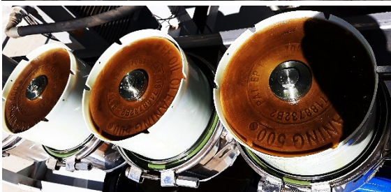
نانو فیلترهای سلولزی مدل EF۵۰۰HY قبل و پس از تصفیه روغن
