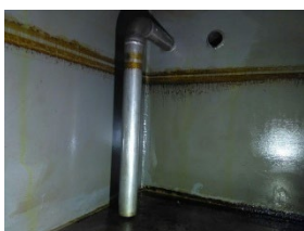
رسوب وارنیش در مخزن روغن و مدار روانکاری توربین VRS6-HE
