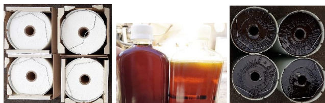
نانو فیلترهای سلولزی قبل و پس از فیلتراسیون
