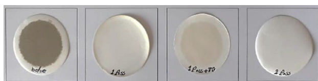
تصویر کاغذهای تست وارنیش در هر مرحله از پروژه
