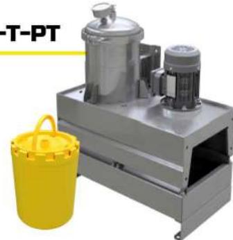
خانواده محصولات Power Train، برای حذف آلودگی‌های موجود در دیزل و نفت سفید تارده ۱/۰ میکرون، شامل انواع باکتری‌ها، آب، محصولات ناشی از فرآیند اکسیداسیون (لجن، وارنیش و رزین) و سیلوکسین کاربرد دارد. این محصولات در هفت ردۀ یک، دو، سه، چهار، شش، نه و دوازده فیلتره، با گستره متنوعی از الکتروپمپ‌ها به صورت نصب روی زمین قابل عرضه است. در این دستگاه‌ها از کارتریج‌های خانواده DXPT استفاده می‌شود.
