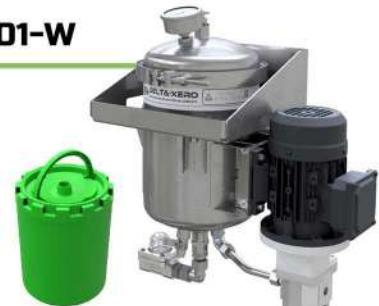
خانواده محصولات فیلتراسیون قابل نصب روی دیوار شامل سه گروه است: دستگاه‌های تک فیلتره (DX1001-W) تا حجم ۴۵۰۰ لیتر و دبی ۱/۲۵ لیتر بر دقیقه، دو فیلتره (DX1002-W) تا حجم ۹۰۰۰ لیتر و دبی ۲/۵ لیتر بر دقیقه، و سه فیلتره (DX1003-W) تا حجم ۱۳۵۰۰ لیتر و دبی ۳/۷۵ لیتر بر دقیقه. این خانواده برای تصفیه انواع روغن‌های هیدرولیک، روانکاری، و روغن سوخت و حذف انواع آلودگی‌ها تارده ۱/۰ میکرون قابل استفاده است. این محصولات در نسخه‌های ضدانفجاری، با انواع موتورها و تجهیزات جانبی نیز عرضه می‌شود.
