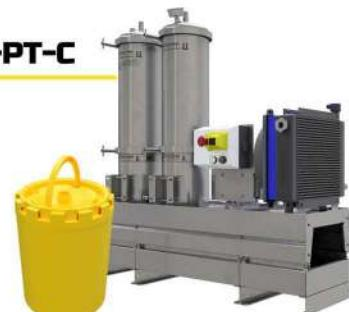
محصولات این خانواده برای تصفیه آلودگی‌های دیزل در توربین‌های گازی تارده ۱/۰ میکرون به کار می‌رود. این خانواده شامل دستگاه‌های یک، دو، سه، چهار، شش، نه و دوازده فیلتره تا حجم ۱۲۰۰ لیتر و تا دبی ۶ لیتر بر دقیقه است. این دستگاه‌ها ججهز به سیستم خنک کننده برای حذف گستره وسیعی از آلودگی‌ها هستند و در آنها از کارتریج‌های خانواده DXPT استفاده شده است. علاوه بر این، این دستگاه‌ها، با استفاده از انواع الکتروپمپ‌ها مناسب با کاربردهای گوناگون عرضه می‌شود.
